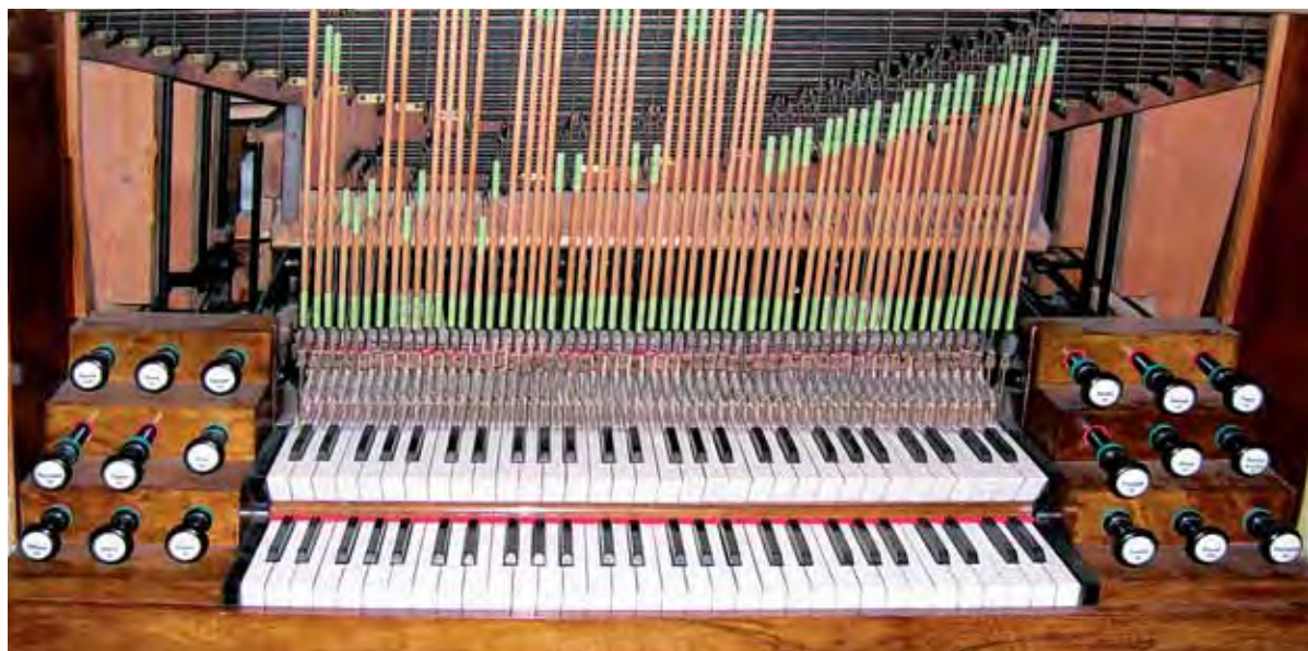
Fagagna, chiesa di S. Giacomo, organo di B. Zanin. Tastiere, tiranti dei registri e meccanica delle tastiere.
